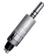
721885 Micromotore pneumatico spray esterno. 20.000 rpm. Innesto E-Type. Ghiera per inversione di marcia. Attacco 4 vie Midwest®
