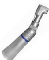
721887 Contrangolo cieco. Rapporto 1:1. Spray esterno con clip. Velocità massima 20.000 rpm. Morsetto a leva. Attacco ISO-Standard/E-Type
